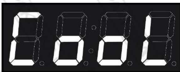
Рисунок 19. Требуется охлаждение камеры
